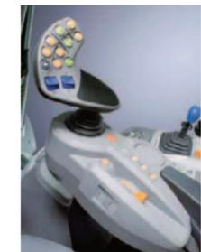
Serie 6: RCshift-Getriebe – schalten per Knopfdruck. Führend in punkto Spar-samkeit – 50 km/h bei nur 1.447 U/min.
