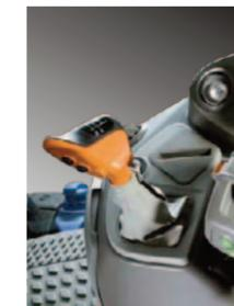
Das effiziente Allround-Getriebe für manuelles Schalten (Serie 6): Powershift Lastschaltgetriebe. 6-fach Lastschaltung
