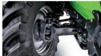
Einmalige Vorderachs-federung über Längsschwinge stufenlos
