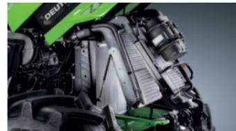
Große Kühler, einfach zu reinigen
